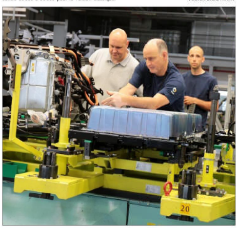
Le montage du modèle électrique (la batterie) au sein de l'usine de production de Smart à Hambach. Photo Thierry MCDOLAN
