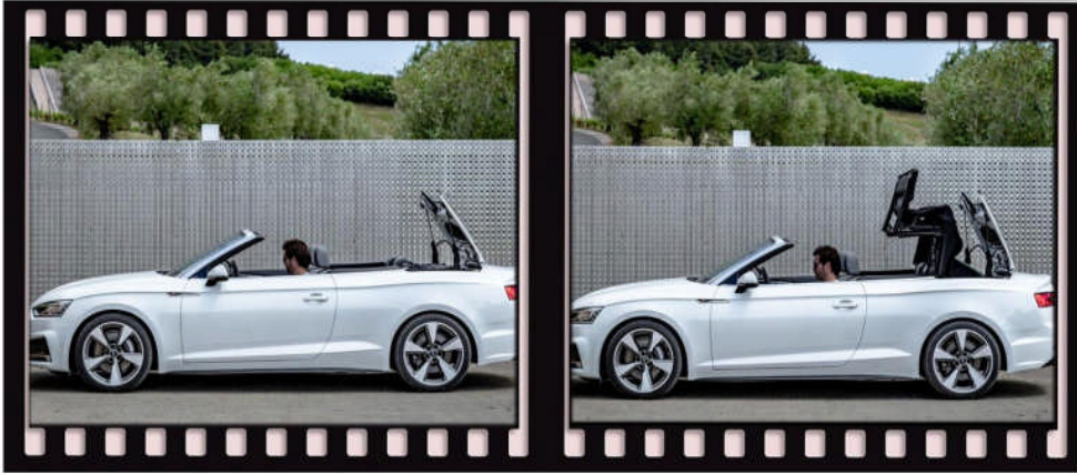
Par une seule impulsion sur la commande, la capote s'ouvre en 15 secondes et se ferme en 18 secondes. Photo DR
