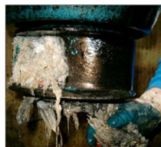
Les lingettes obstruent les canalisations et bloquent les pompes. Photo DR
