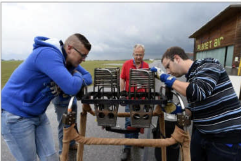
Malgré la pluie qui sévissait hier, des aérostiers réparent et réglent la veuleuse d'un brûleur.
