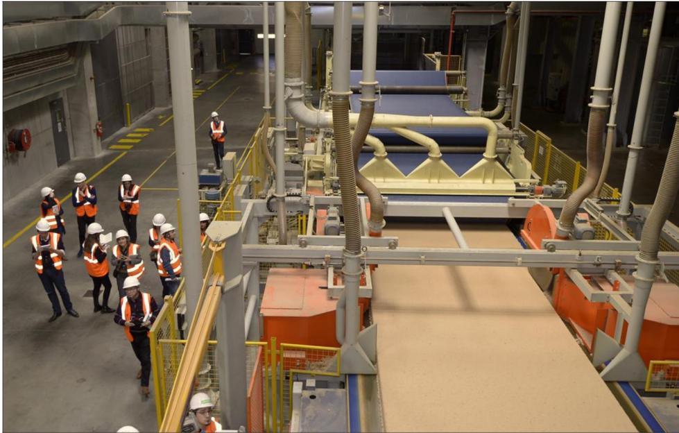
À Golbey, Pavatex produit 42 000 tonnes de panneaux isolants rigides en fibre de bois. Un procédé de fabrication ultra-moderne et écologique pour un produit à haute performance énergétique. Photo VMJ/Jean-Charles OLE
