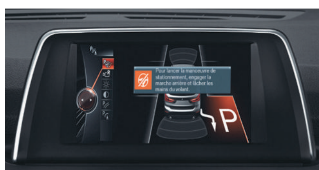
Système de manœuvres automatiques « Park Assist ».
