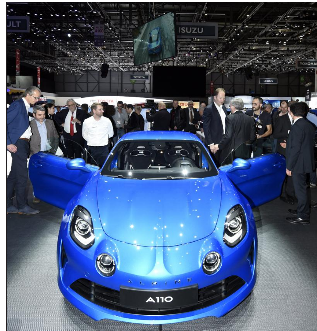
Composée à 96% d'aluminium, un métal très léger, l'Alpine A110 affiche un poids plume de 1 103 kg propulsé par un moteur 1,8 L turbo 4 cylindres de 252ch. Photo ER/Alexandre MARCHI
