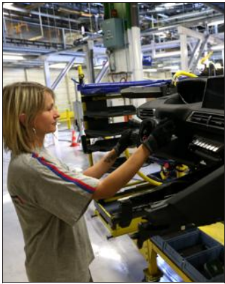
Préparation du i-cockpit (poste de conduite) du Peugeot 3008. Photo ER
