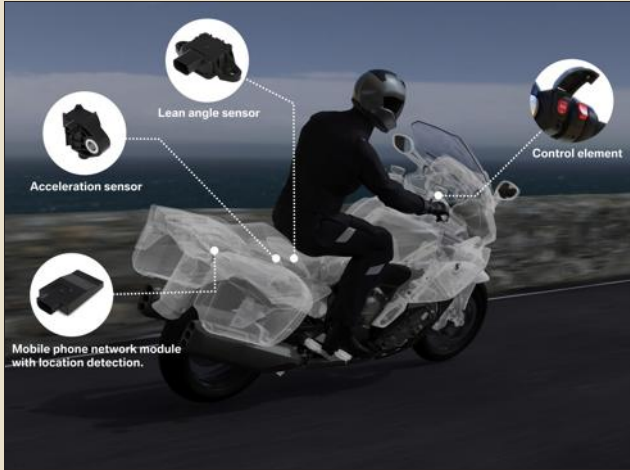
Des capteurs placés à des endroits stratégiques pourront détecter la moindre chute. Photo BMW
