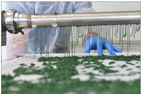
La substance verte passe dans un pressoir et ressort sous forme de spaghettis avant d'être séchée et conditionnée. Photo ER
